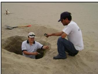
Calicata de Perfil estratigráfico para relleno sanitario en Casma. EIA aprobado por DIGESA
